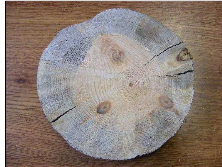
PĘKNIĘCIA I SINIZNA
