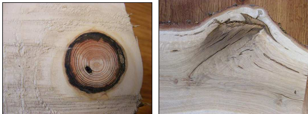
Rysunek 1.5. Sęki wg [36]: a) zdrowy, częściowo zrośnięty sęk okrągły na stycznej płaszczyźnie tarcicy, b) zdrowy, zrośnięty sęk owalny na promieniowej płaszczyźnie tarcicy, c) sęk podłużny smołowy (zepsuta tkanka przesycona żywicą), d) zdrowy sęk skrzydlaty na promieniowej płaszczyźnie tarcicy
