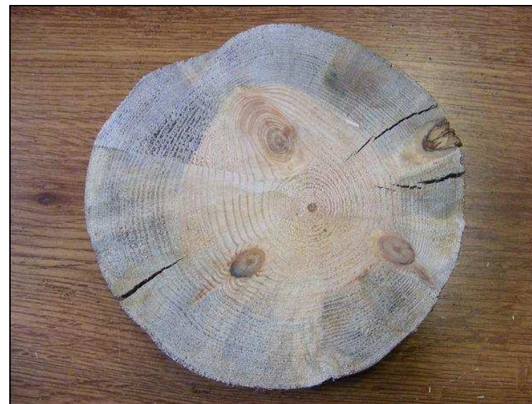
PĘKNIĘCIA I SINIZNA
